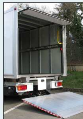
Hayon élévateur de chargement + auvent supérieur de fermeture + rail d'arrimage
