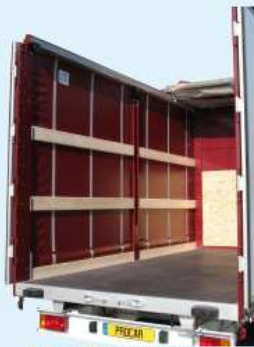
Option : Toit bâché coulissant avec traverse AR embarquée
