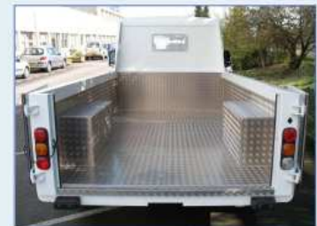
Doublage parois & plancher
